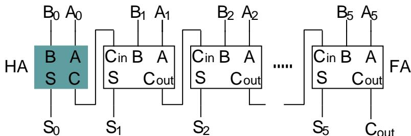
[発展] 左図のような回路構成では、 $A_0+B_0$  の桁上げを使って  $A_1+B_1$  を計算→その桁上げを使って  $A_2+B_2$  を計算→…というように計算が進む。そのため、桁数が多くなると信号が何段もの論理回路を通過しなければならず、計算にかかる時間が長くなる。実用的な加算器ではこのような問題を避ける工夫がなされていることが多い。
