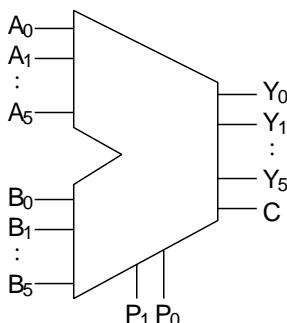
A, B: 6bit の入力, Y: 6bit の出力, C: 桁上げ出力
