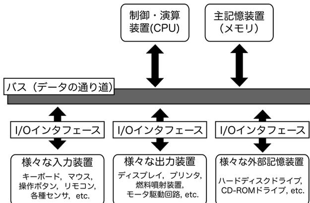
☆7) この図では 1 本のバスに全ての装置が接続されているが、最近の PC などでは、独立したバスを複数用意して (例えば CPU とメモリ間専用など) 性能向上をはかっているものも多い。
