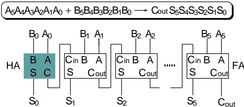
[発展] 左図のような回路構成では、 $A_0+B_0$  の桁上げを使って  $A_1+B_1$  を計算→その桁上げを使って  $A_2+B_2$  を計算→…というように計算が進む。そのため、桁数が多くなると信号が何段もの論理回路を通過しなければならない、計算にかかる時間が長くなる。実用的な加算器ではこのような問題を避ける工夫がなされていることが多い。
