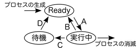
プロセスは、**スケジューラ** (☆6) の制御に従って状態を遷移させる。CPU が 1 つのコンピュータでは、複数のプロセスが同時に実行中になることはできない。図のそれぞれの状態遷移は次のような時に起こる。
