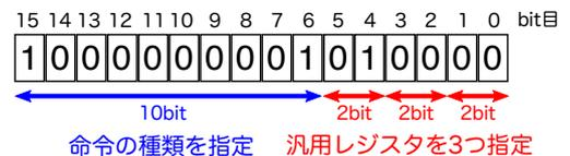
命令の種類を表すビットパターンなどの決め方は 1. と同様にすればよい。ただし、この命令が  $16 \times 2$  ビットでできていることを実行制御装置がわかるように、最初の 10 ビットは 1. と重複しないビットパターンとする必要がある。例えば 1000000000 はメモリからレジスタへの情報の転送、1000000001 は逆にレジスタからメモリへの転送を表す命令とする (これらの命令ではレジスタを 1 つだけ指定するので、例えば 6 ビットのうち上位の 2 ビットだけを使い残りは無視すればよい)。
