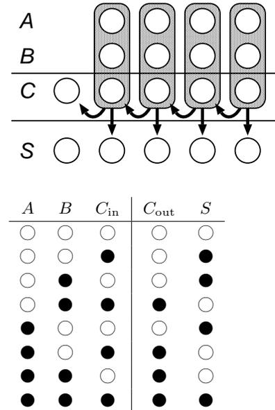
上記の表の  $A, B, C_{in}$  に対応した○●の値を入力すると  $S, C_{out}$  に対応した○●を出力する仕掛けを下図左のように表すこととする。これを下図右のように組み合わせると, 上記の計算を下位桁から順に実行できるような仕掛けを作ることができる。
