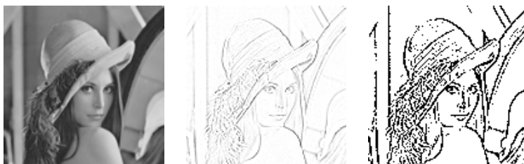
図 3: フィルタリングとしきい値処理の組み合わせの例。左から順に、元画像，フィルタリングして絶対値をとったもの（見やすくするため白黒を反転してある），それを二値化したもの。
