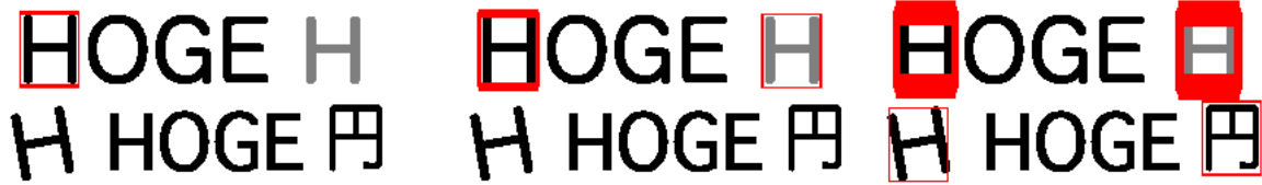
図 3: テンプレートマッチング。下段の 3 つの画像では、MSE の値が基準より小さかった位置にテンプレートと同サイズの赤枠を表示している。左のものほど MSE の基準が小さい (厳しい)。
