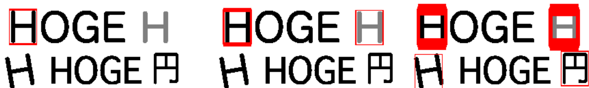
図 8: テンプレートマッチング。下段の 3 つの画像では、MSE の値が基準より小さかった位置にテンプレートと同サイズの赤枠を表示している。左のものほど MSE の基準が小さい (厳しい)。
