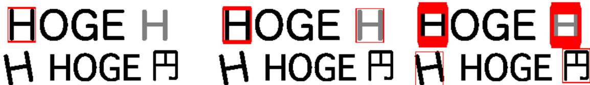
図 8: テンプレートマッチング。下段の 3 つの画像では、MSE の値が基準より小さかった位置にテンプレートと同サイズの赤枠を表示している。左のものほど MSE の基準が小さい (厳しい)。
